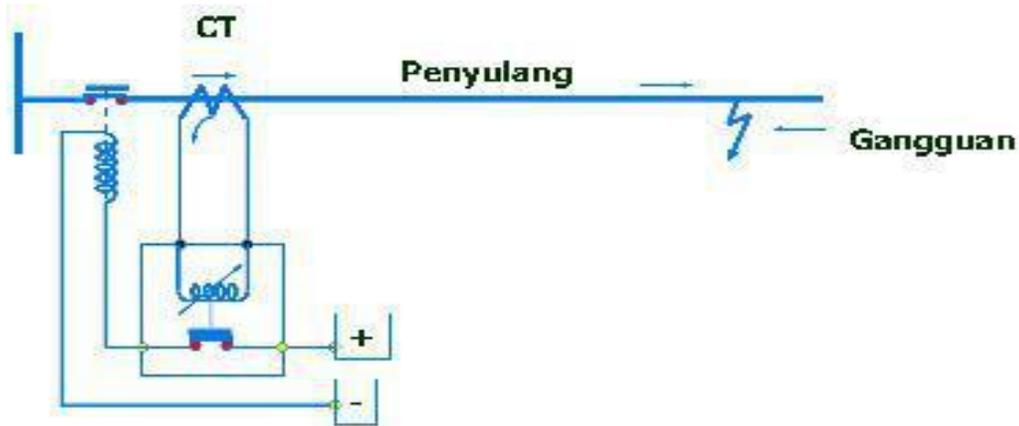
Gambar 2.6 sistem kerja relay
