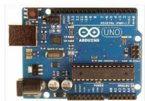
Gambar 2. 3 Bentuk Fisik Arduino UNO
