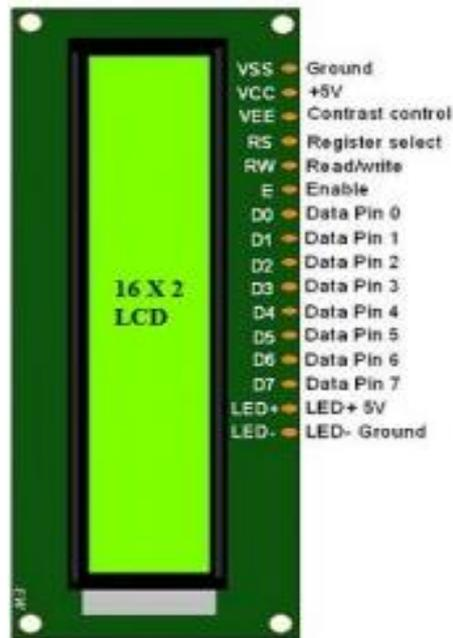
**Gambar 2. 8** Konfigurasi Pin LCD
