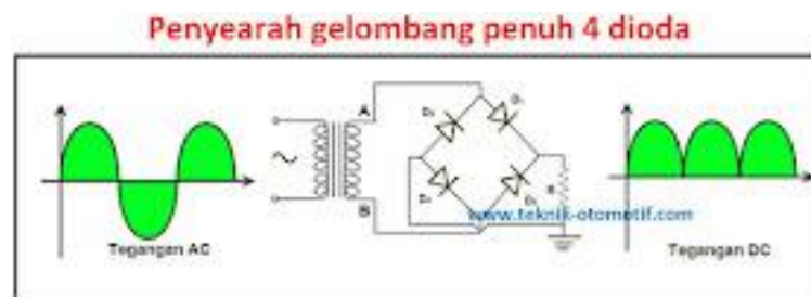
Gambar 2.10 Skema penyearah gelombang penuh sistem jembatan
