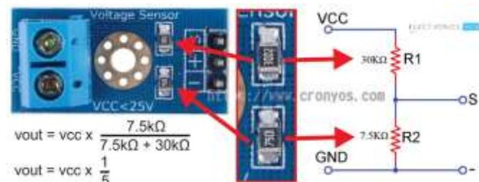
Gambar 2. 37 modul sensor tegangan
