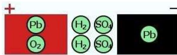
**Gambar 2. 14** Ilustrasi baterai dalam keadaan terisi penuh[15]
