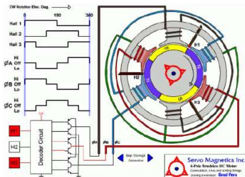
**Gambar 2. 19** Skema Kerja Motor BLDC[33].
