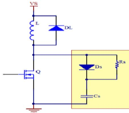
**Gambar 2. 23** Rangkaian snubber pada rangkaian switch MOSFET[43]
