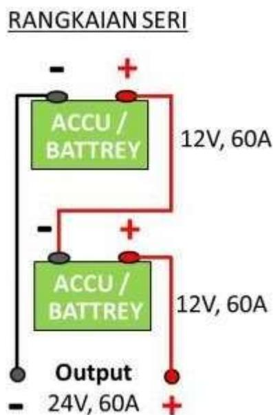
**Gambar 2. 11** Rangkaian Baterai Secara Seri
