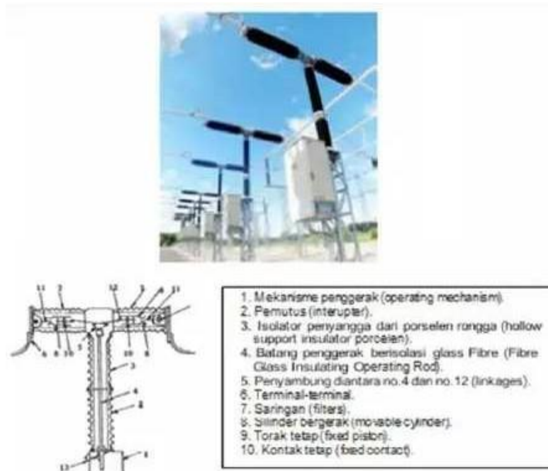
Gambar 2. 17. PMT Satu Katup dengan Gas SF 6
