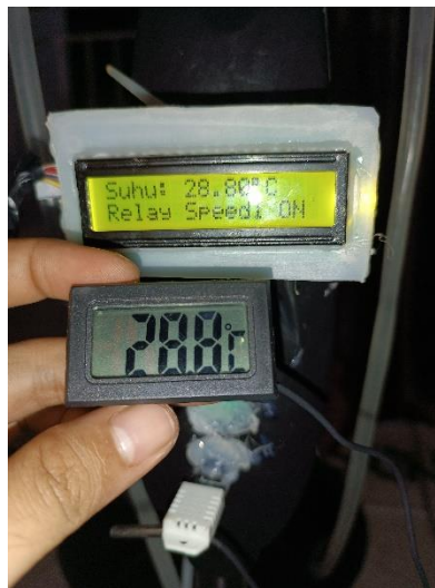
Gambar 2.18 Perbedaan antara Alat Ukur dan DHT 22
