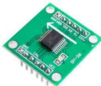
Gambar 2. 8 Sensor Kompas GY-26
