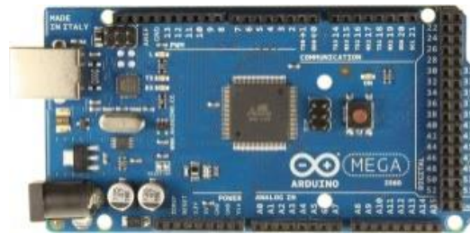
Gambar 2.27 Bentuk Fisik Arduino Mega
