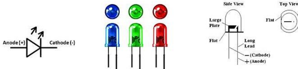
Gambar 2.31 Simbol LED, Bentuk Fisik LED, dan Bagian Penyusun LED
