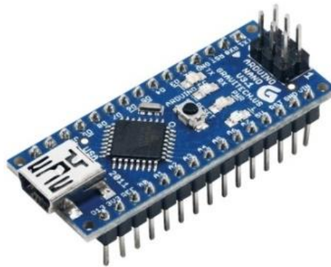
Gambar 2.28 Bentuk Fisik Arduino Nano
