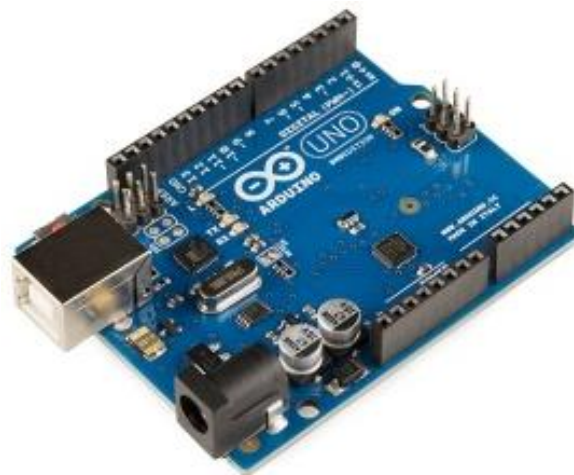
Gambar 2.26 Bentuk Fisik Arduino Uno
