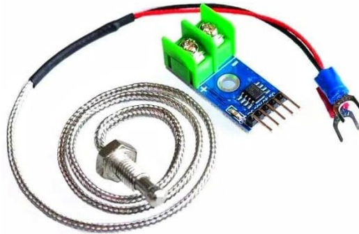
Gambar 2.21 Thermocouple Tipe K dan Modul MAX6675
