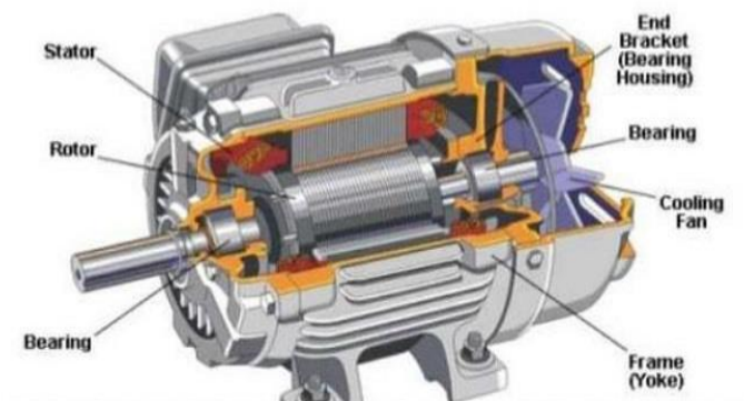
Gambar 2.11 Bagian dalam Dinamo
