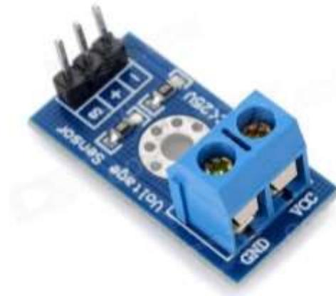
**Gambar 2. 4** Sensor Tegangan
