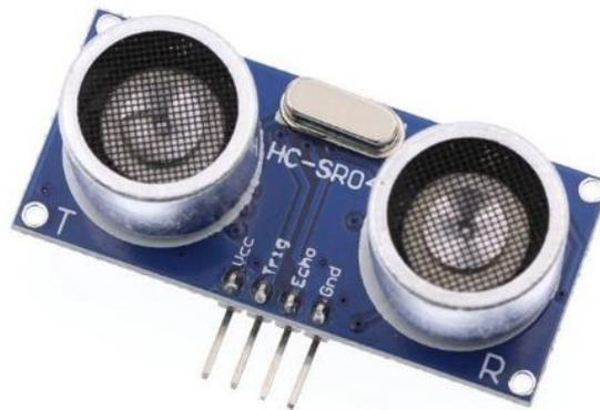
**Gambar 2.5** Bentuk Sensor Ultrasonic
