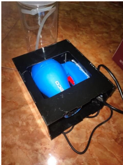
Pemasangan Hair Dryer pada Box Hand Dryer
