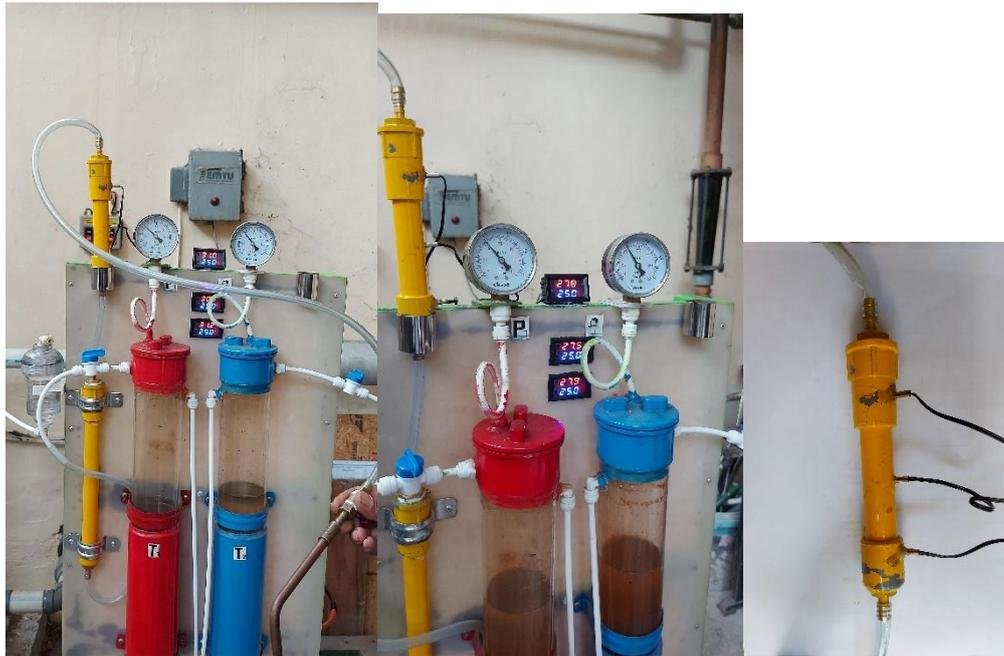
Gambar 1. Rancangan Hydrogen Fuel Generator dan Arrestor
