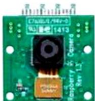
Gambar 2. 4 Modul Kamera Raspberry [14]
