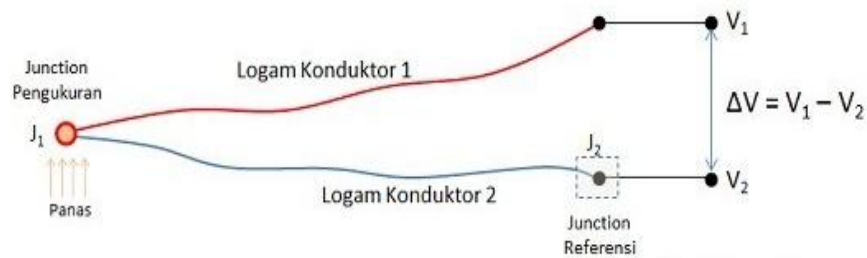
Gambar 2. 29 Cara Kerja Thermocouple
