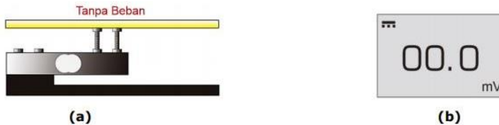
Gambar 2.8 (a) Sensor Load Cell tanpa beban; (b) Skala Avo Meter Digital
