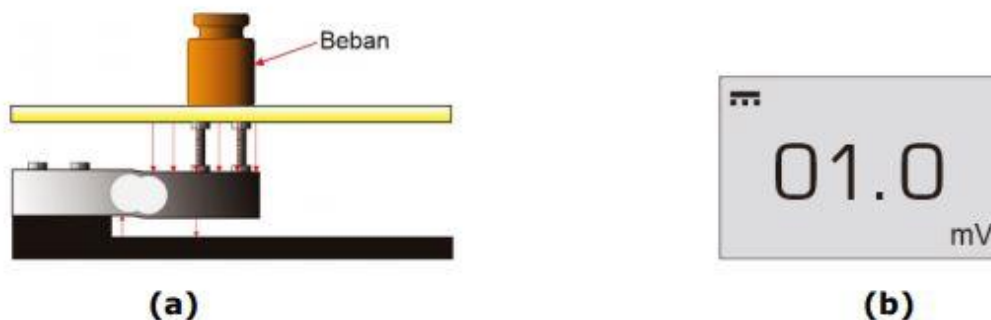
Gambar 2.9 (a) Sensor Load Cell diberi beban; (b) Skala Avo Meter Digital
