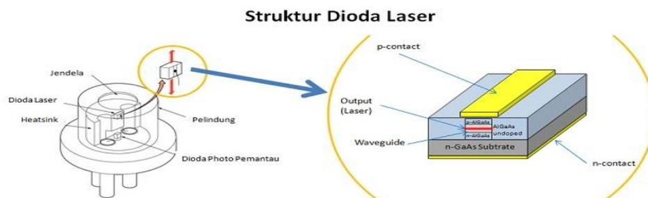
**Gambar 2.4** Struktur Dioda Laser
