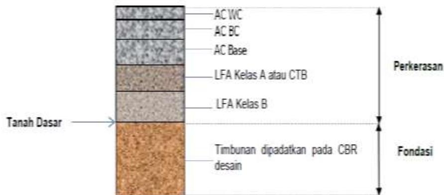
Gambar 2.27 Perkerasan Lentur pada timbunan
