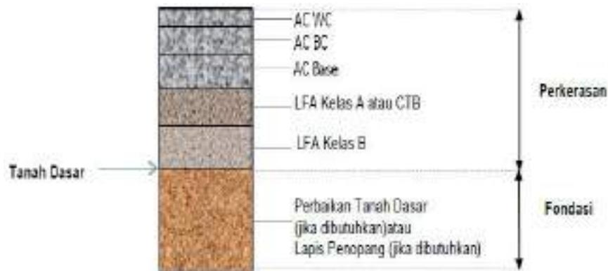
Gambar 2.27 Perkerasan Lentur Pada Permukaan Tanah Asli
