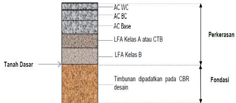
Gambar 2.30 Perkerasan Lentur pada timbunan
