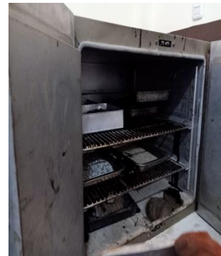
Pengeringan agregat kedalam oven hingga mendapatkan berat konstan
