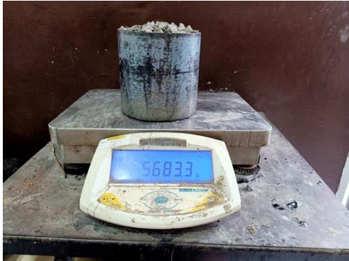
Penimbangan bobot isi gembur agregat 1/1 sampel 2
