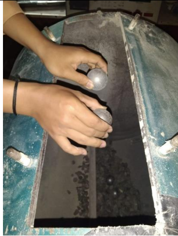
Memasukkan bola-bola baja kedalam mesin abrasi Los Angeles
