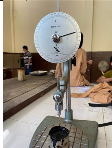
Meletakkan sampel pada alat pentrometer
