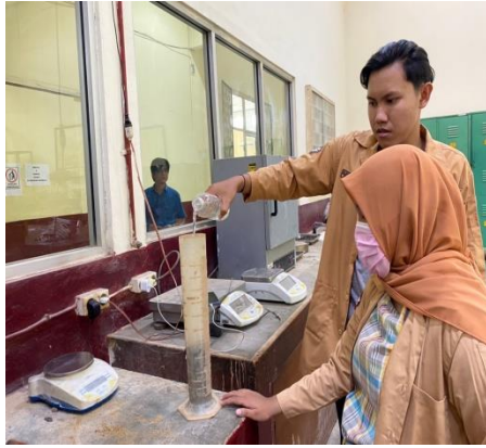
Memasukkan air serta agregat kedalam pycnometer
