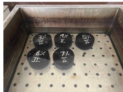
Perendaman benda uji kedalam waterbath
