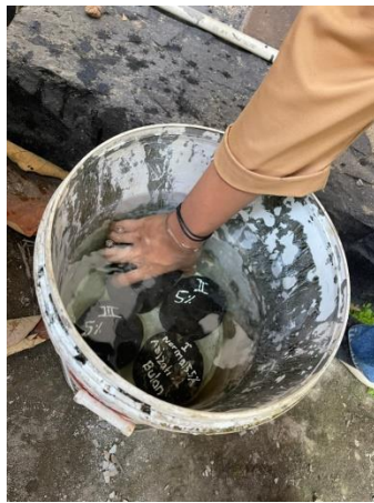
Perendaman benda uji selama \pm 24 jam
