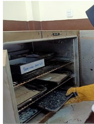
Pengeringan Sample menggunakan oven
