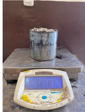
Penimbangan bobot isi gembur agregat 1/2 sampel 1
