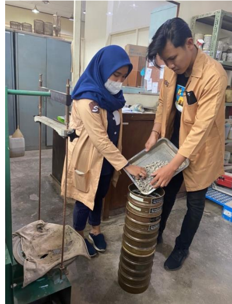
Memasukkan sample Agregat kasar kedalam saringan
