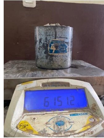
Penimbangan bobot isi padat agregat 1/2 sampel 2
