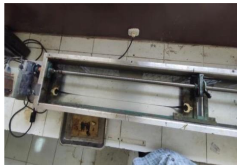
Penarikan aspal yang sudah dicetak dengan mesin penarik
