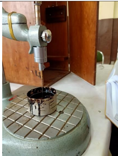
Penurunan jarum diatas permukaan sampel
