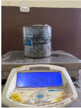
Penimbangan bobot isi padat agregat 1/2 sampel 1
