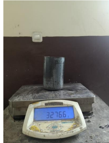
Penimbangan bobot isi gembur Agregat halus sampel 3
