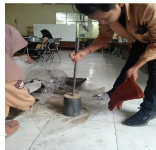
Panumbukkan Agregat Halus di dalam bejana
