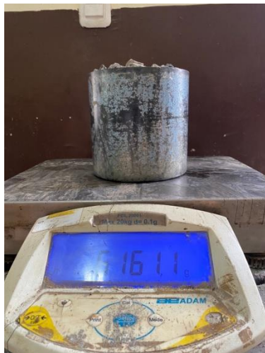
Penimbangan bobot isi padat agregat 1/2 sampel 3
