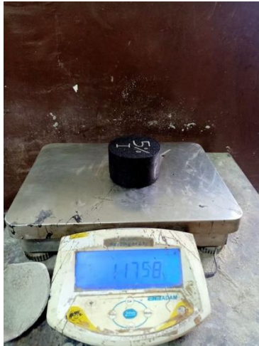
Penimbangan berat jenuh permukaan sampel benda uji campuran aspal modifikasi
