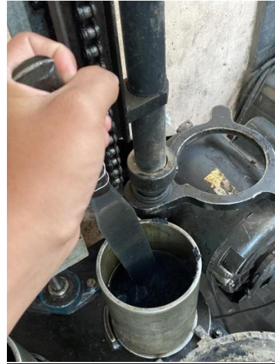
Penumbukan aspal agar rata terhadap cetakan mould
