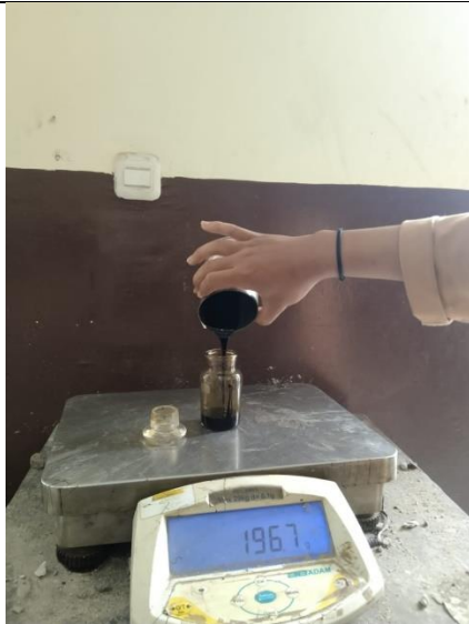
Memasukkan Aspal panas cair kedalam piknometer kaca
