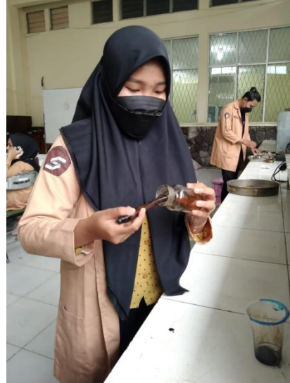
Pengolesan Oli pada piknometer kaca
