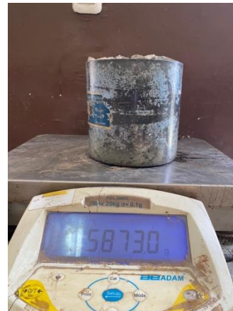
Penimbangan bobot isi gembur agregat 1/2 sampel 3
