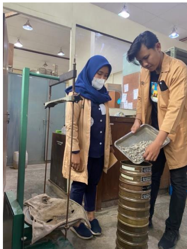
Memasukkan sample Agregat Sedang kedalam saringan
