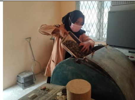
Memasukan sampel kedalam alat abrasi Los Angeles
