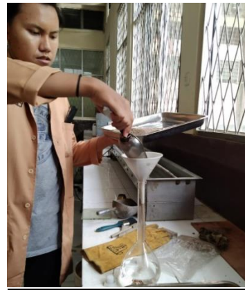
Memasukkan Sample yang sudah SSD kedalam Piknometer kaca
