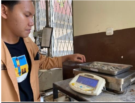
Penimbangan agregat sesuai komposisi yang direncanakan
