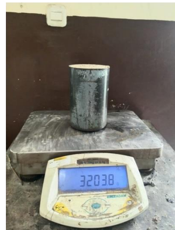
Penimbangan bobot isi gembur Agregat halus sampel 1
