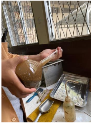
Proses Pengeluaran Gelembung udara Pada sample
