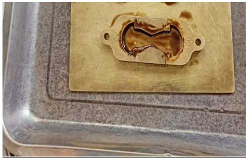
Pengolesan Oli pada cetakkan daktilitas
