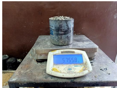
Penimbangan bobot isi gembur agregat 1/1 sampel 1
