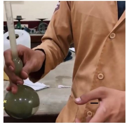
Tabung digoncang sampai gelembung udara hilang
