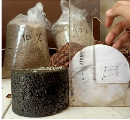
Pengukuran tinggi benda uji yang sudah dikeluarkan dari cetakkan
