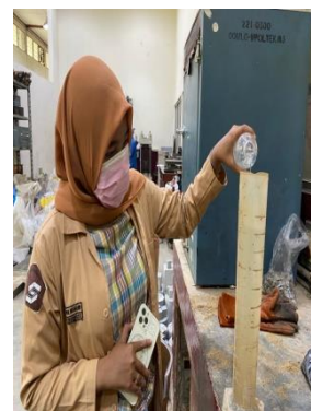
Memasukkan air kedalam piknometer
