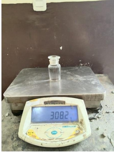
Penimbangan Piknometer & tutup
