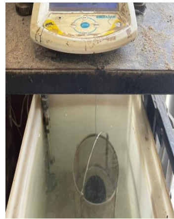
Penimbangan berat benda uji dalam air
