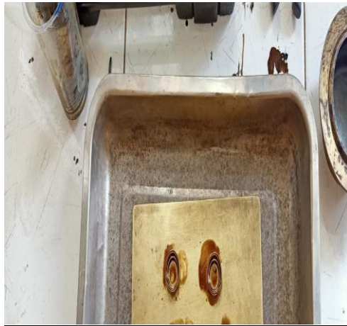
Pengolesan oli pada cetakan
