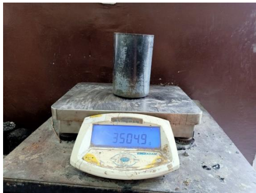
Penimbangan bobot isi padat Agregat halus sampel 1
