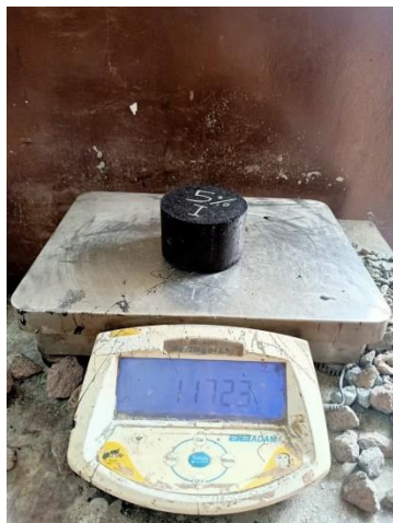
Penimbangan berat kering sampel benda uji campuran aspal modifikasi
