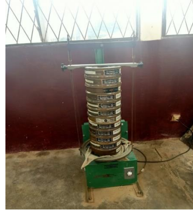
Proses pengayakan Agregat
