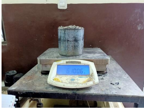
Penimbangan bobot isi padat agregat 1/1 sampel 1
