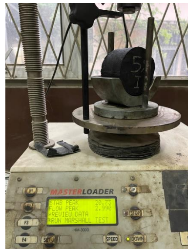
Pengujian Marshall sample benda uji campuran aspal modifikasi
