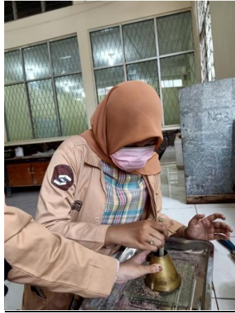
Penumbukkan sample untuk mendapatkan hasil SSD
