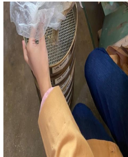
Memasukkan sample Agregat Halus kedalam saringan
