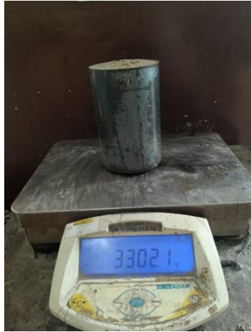
Penimbangan bobot isi gembur Agregat halus sampel 2
