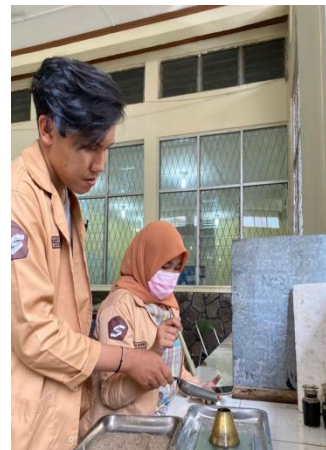
Memasukkan sample kedalam Kerucut Terpancung
