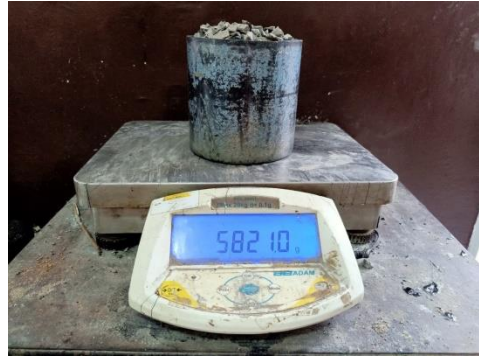
Penimbangan bobot isi gembur agregat 1/1 sampel 3
