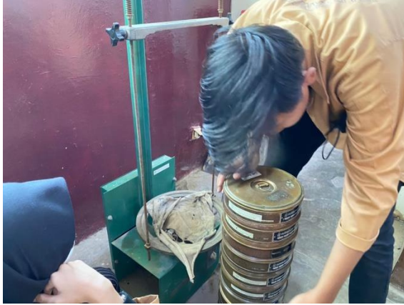
Saringan berisi sample dipasang pada alat ayakan
