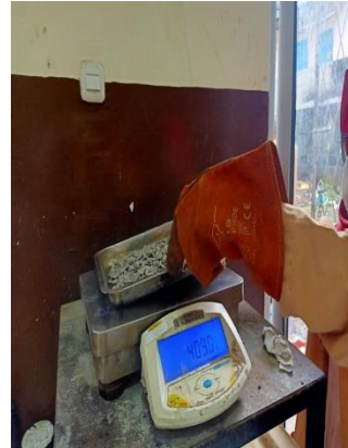
Penimbangan Sample Kering yang sudah konstan
