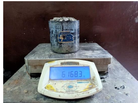
Penimbangan bobot isi padat agregat 1/1 sampel 2
