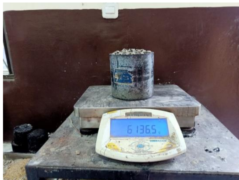
Penimbangan bobot isi padat agregat 1/1 sampel 3
