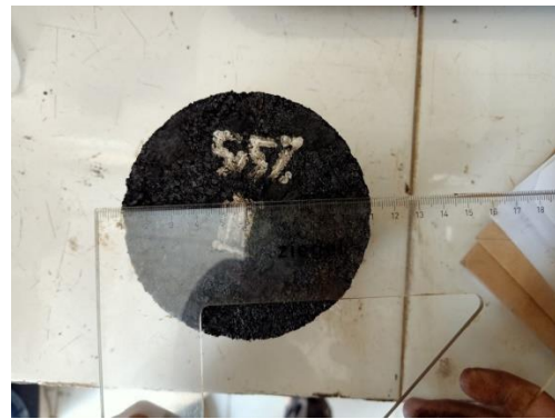
Pengukuran lebar benda uji yang sudah dikeluarkan dari cetakan
