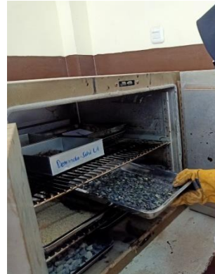
Pengeringan Agregat kedalam Oven
