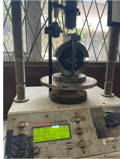
Pengujian benda uji menggunakan alat uji Marshall
