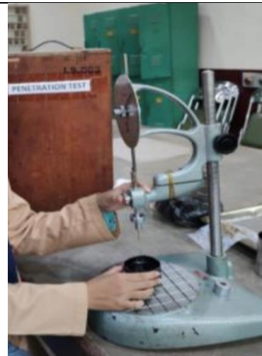
Pengujian Aspal menggunakan alat pentrometer
