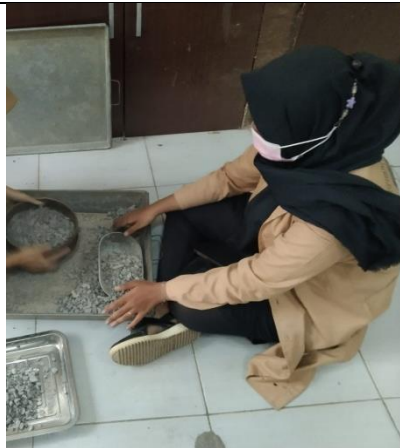
Pengayakan agregat dengan saringan 2,36
