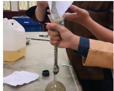
Pemasukkan semen kedalam tabung Le Chatelier Flask
