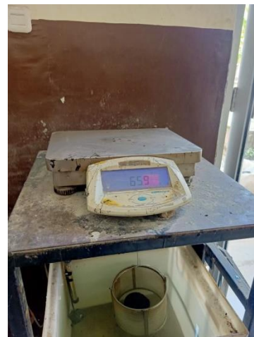
Penimbangan berat dalam air permukaan sampel benda uji campuran aspal modifikasi
