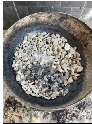
Pencampuran plastik menggunakan cara kering
