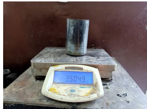
Penimbangan bobot isi padat Agregat halus sampel 2
