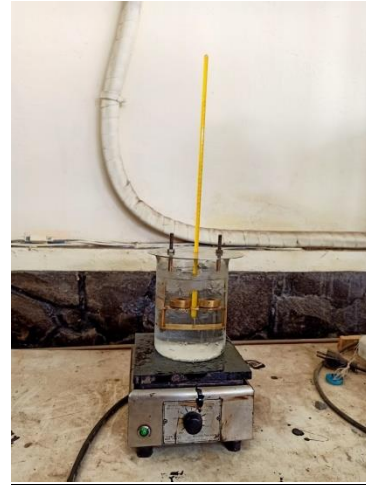
Memasukkan sampel kedalam bejana tahan panas dengan air suhu 5°
