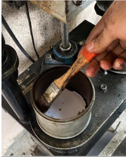
Pengolesan oli ke sisi mould panas yang sudah di alasi kertas
