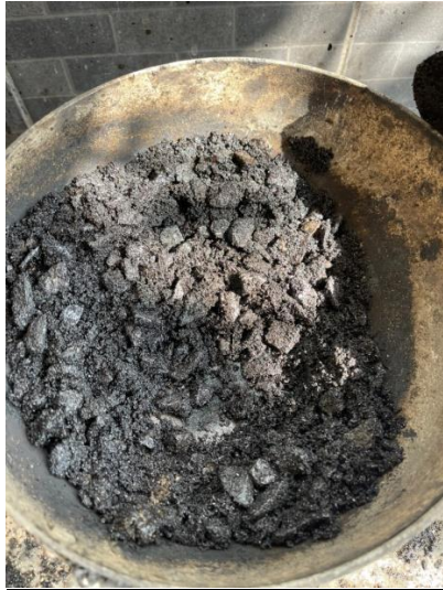
Perataan benda uji modifikasi hingga homogen
