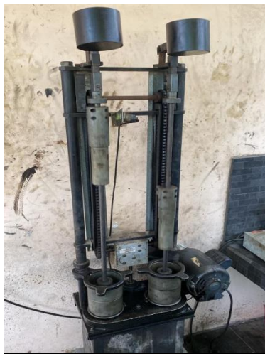
Penumbukkan benda uji menggunakan alat Marshall
