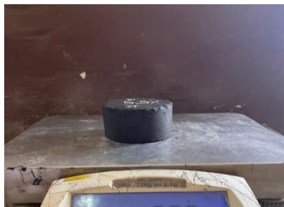
Penimbangan berat benda uji dalam keadaan jenuh permukaan
