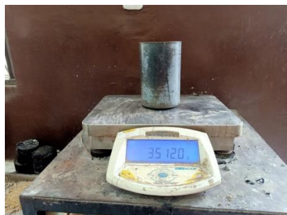
Penimbangan bobot isi padat Agregat halus sampel 3
