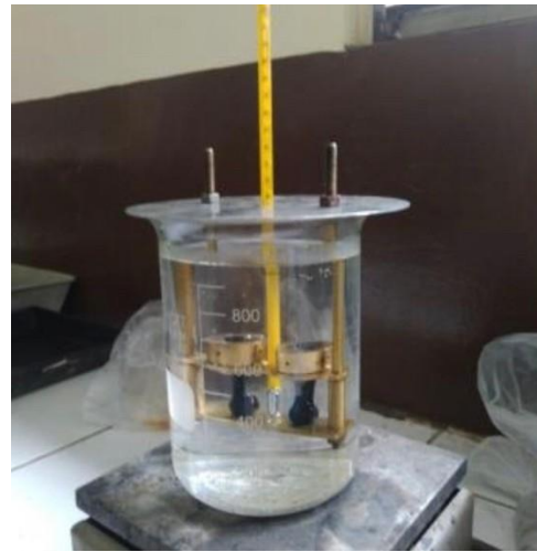
Pembacaan & pencatatan suhu dan waktu jatuhnya bola baja menyetuh dudukan benda uji
