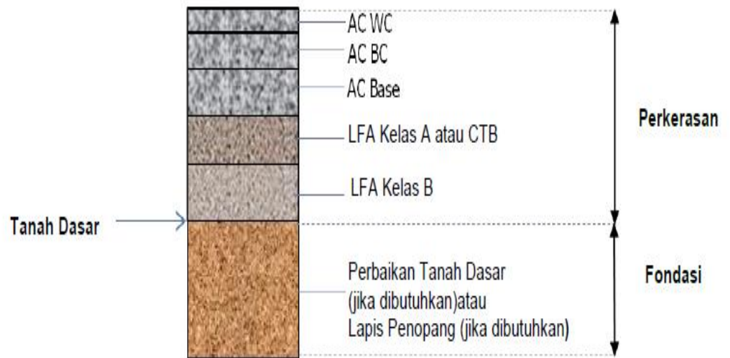
Gambar 2.28 Perkerasan Lentur Pada Permukaan Tanah Asli
