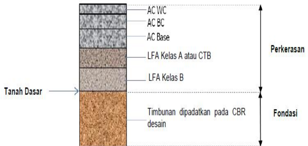
Gambar 2.29 Perkerasan Lentur pada timbunan
