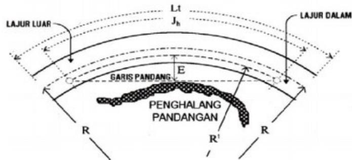
**Gambar 2.24** Daerah bebas samping ditikungan untuk  $J_h < L_t$
