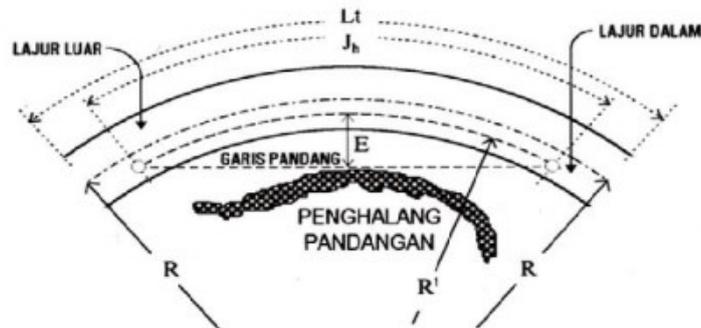
**Gambar 2.25** Daerah bebas samping ditikungan untuk  $J_h > L_t$
