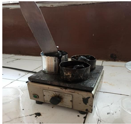
4. Proses pemasakan aspal
