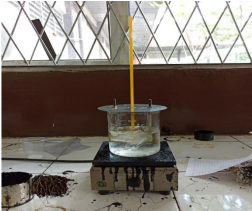
3. Proses pengambilan data titik lembek
