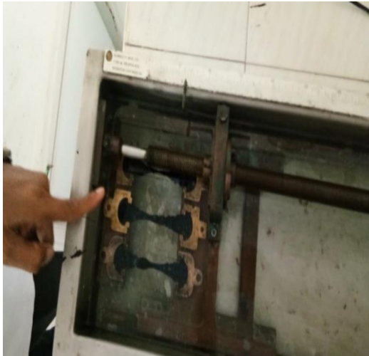
1. Proses pengujian Daktilitas
