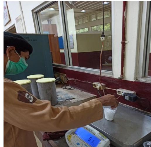
6. Penimbangan kadar persen styrofoam
