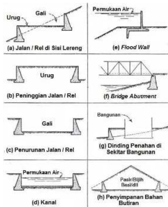
Gambar 2. 1 Kegunaan Dinding Penahan Tanah (Sumber: Huntington, 1961)
