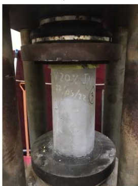
Pengujian Kuat Tekan Beton
