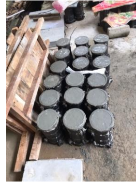
Pencetakan Benda Uji
