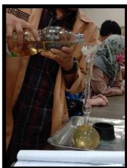
Pengisian Minyak Tanah Pada Tabung Le Chatelier Flask
