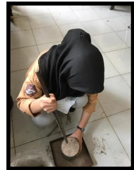
Penumbukan Bobot Isi Agregat
