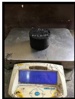
Penimbangan Benda Uji Kondisi Kering
