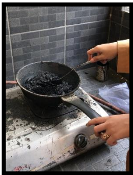
Pengadukan Campuran Agregat dan Aspal
