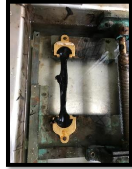
Proses Penarikan Benda Uji Daktalitas
