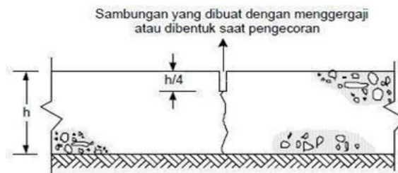
Gambar 2.25 Sambungan susut melintang tanpa ruji
