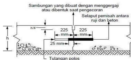
Gambar 2.26 Sambungan susut melintang dengan ruji
