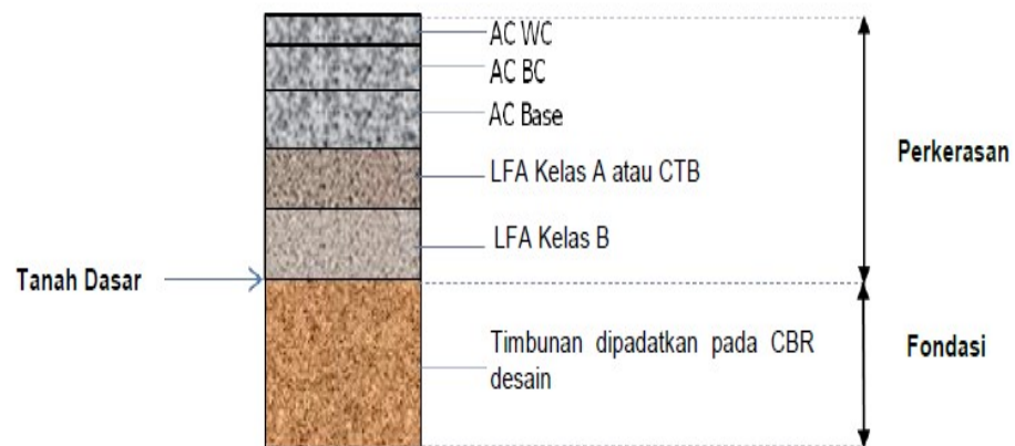
Gambar 2.26 Perkerasan Lentur pada timbunan
