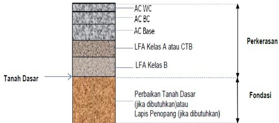
Gambar 2.25 Perkerasan Lentur Pada Permukaan Tanah Asli
