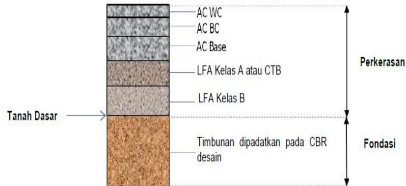
Gambar 2.27 Perkerasan Lentur pada timbunan
