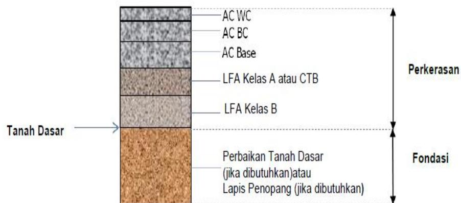
Gambar 2.26 Perkerasan Lentur Pada Permukaan Tanah Asli
