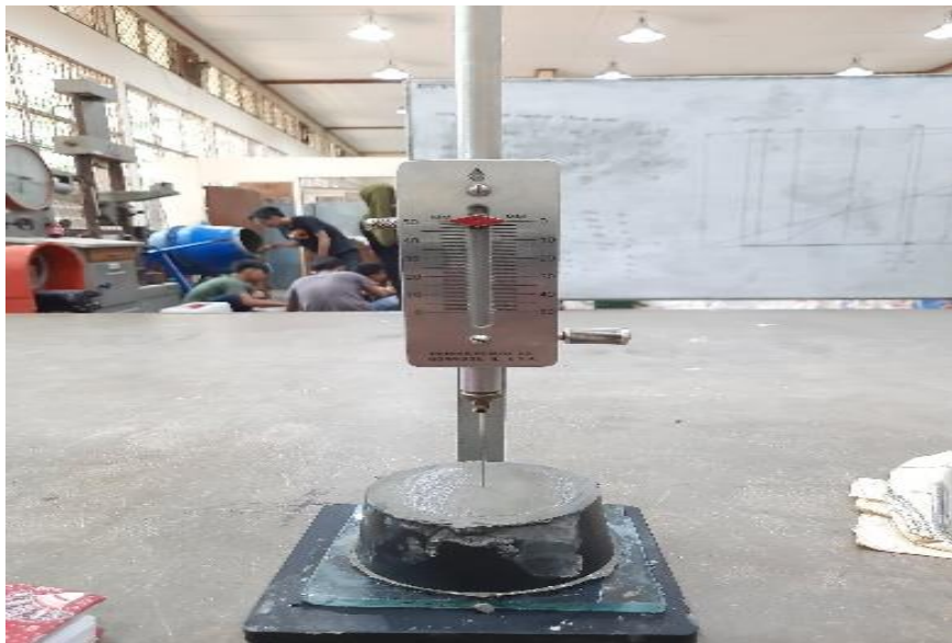
Gambar 32. Pembacaan penurunan jarum alat Vicat pada pengujian waktu ikat semen
