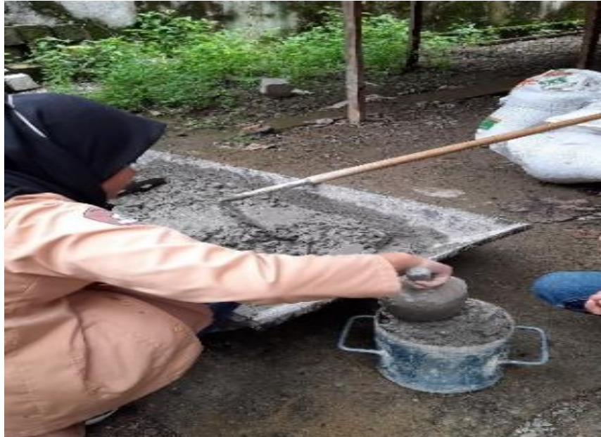
Gambar 25. Beton segar dimasukkan kedalam bejana silinder dalam 3 lapisan dan Tiap lapis beton segar yang dimasukkan ke dalam bejana silinder ditumbuk sebanyak 25 kali lalu ditimbang
