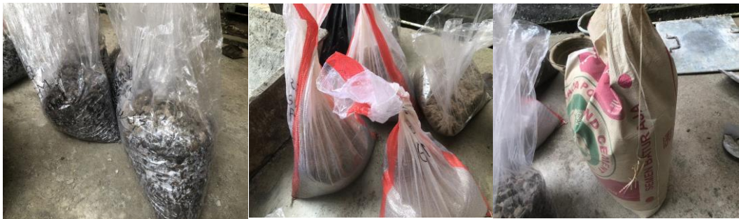
Gambar 33. Material yang telah diuji dan memenuhi syarat yang sudah ditentukan untuk campuran beton, ditimbang sesuai dengan perencanaan perhitungan Job Mix Formula
