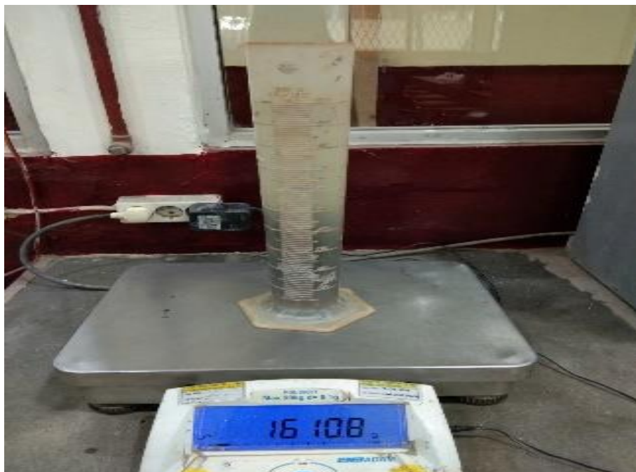
Gambar 8. Penimbangan berat gelas ukur berisi air dan agregat kasar yang telah direndam selama 24 jam
