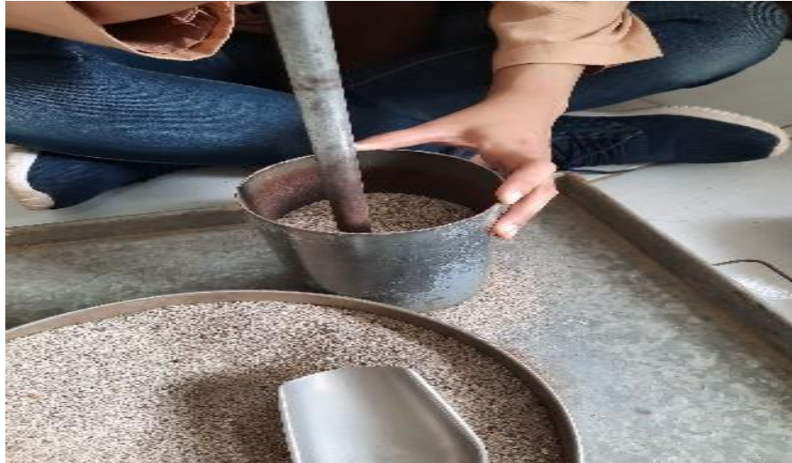
Gambar 13. Pada pengujian bobot isi gembur bejana diisi agregat halus sampai penuh dengan ketinggian maksimum penuangan 5 cm
