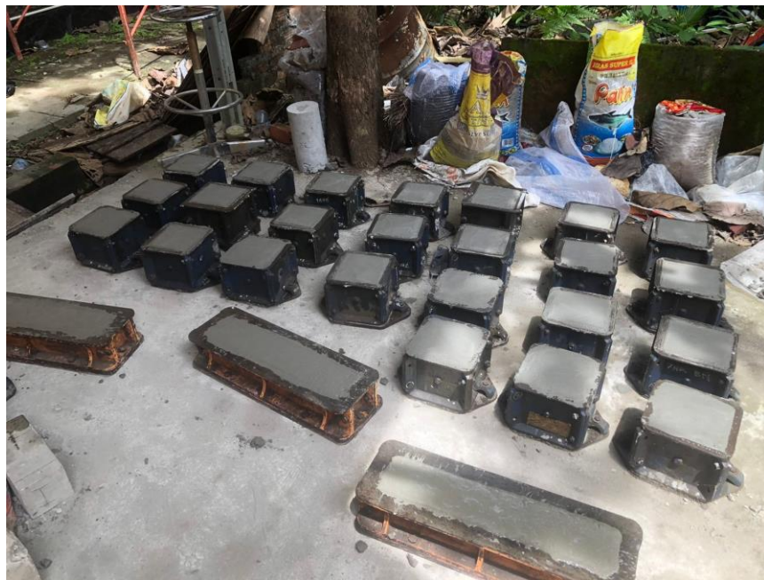
Gambar 38. Campuran beton dimasukkan ke dalam cetakan benda uji
