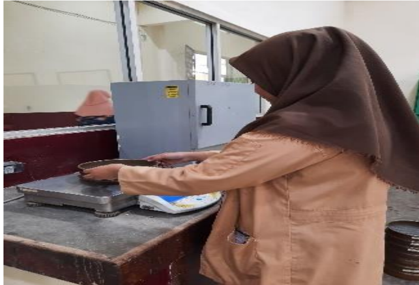
Gambar 1. Penimbangan berat agregat halus yang tertahan di tiap nomor saringan
