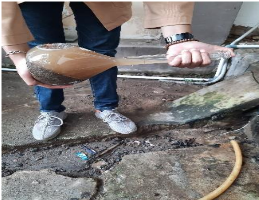
Gambar 6. Agregat dalam keadaan SSD dan air bersih dimasukkan ke dalam piknometer kaca lalu diguncang sampai gelembung udaranya hilang.
