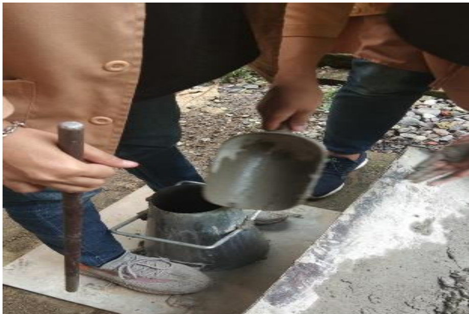
Gambar 22. Tiap lapisan beton segar yang dimasukkan ke dalam kerucut Abrams
