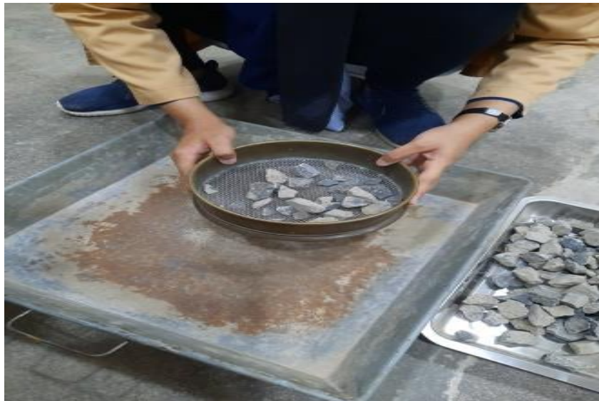
Gambar 18. Agregat disaring menggunakan ayakan nomor 10 & 14 mm untuk dimasukkan kedalam bejana
