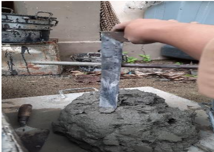
Gambar 24. Pembacaan nilai uji slump menggunakan mistar
