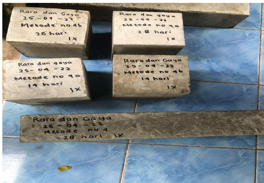
Gambar 48. Beton metode dengan penyiraman beton rutin 1 kali sehari pada siang hari.
