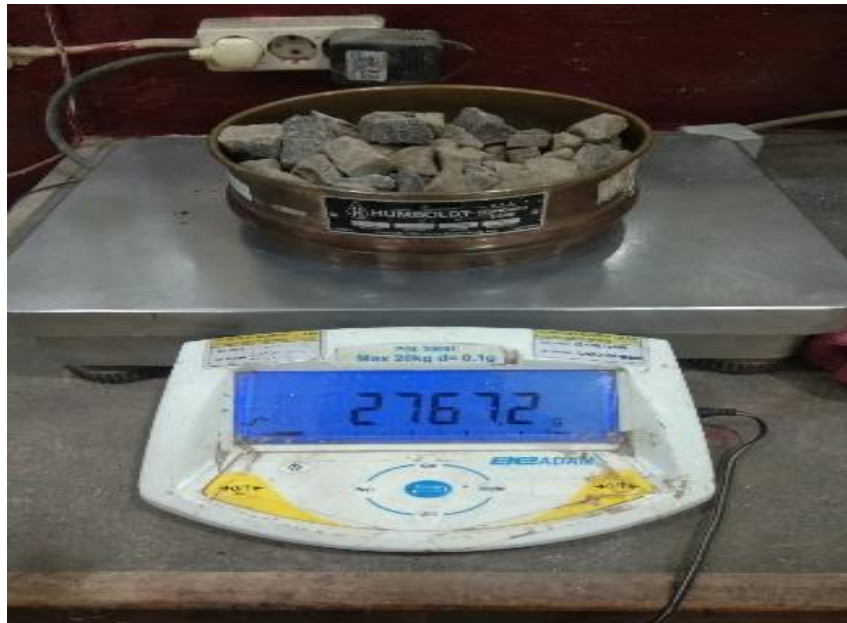
Gambar 3. Pengujian analisa saringan agregat kasar menggunakan mesin ayak
