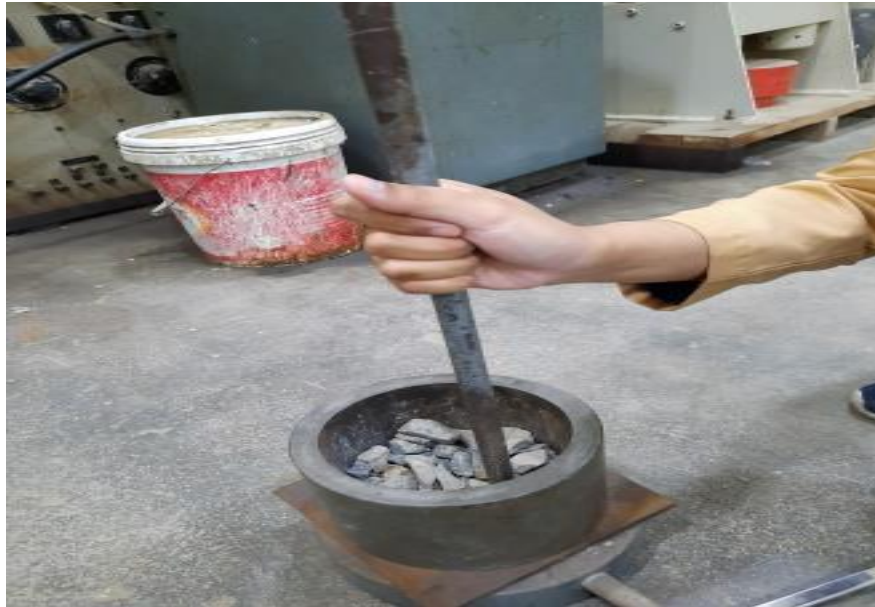
Gambar 19. Agregat dimasukkan kedalam bejana dalam 3 lapisan dan ditumbuk sebanyak 25 kali tiap lapisnya
