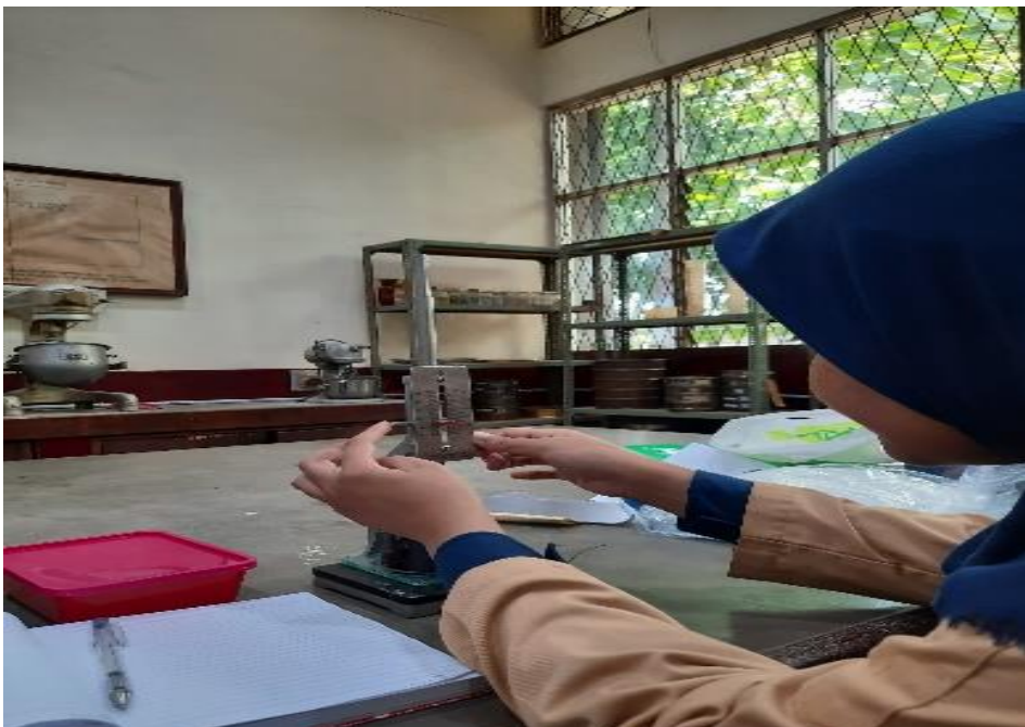
Gambar 30. Pengujian konsistensi semen dengan menggunakan alat Vicat
