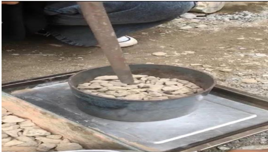
Gambar 16. Pada pengujian bobot isi gembur bejana diisi agregat kasar sampai penuh dengan ketinggian maksimum penuangan 5 cm
