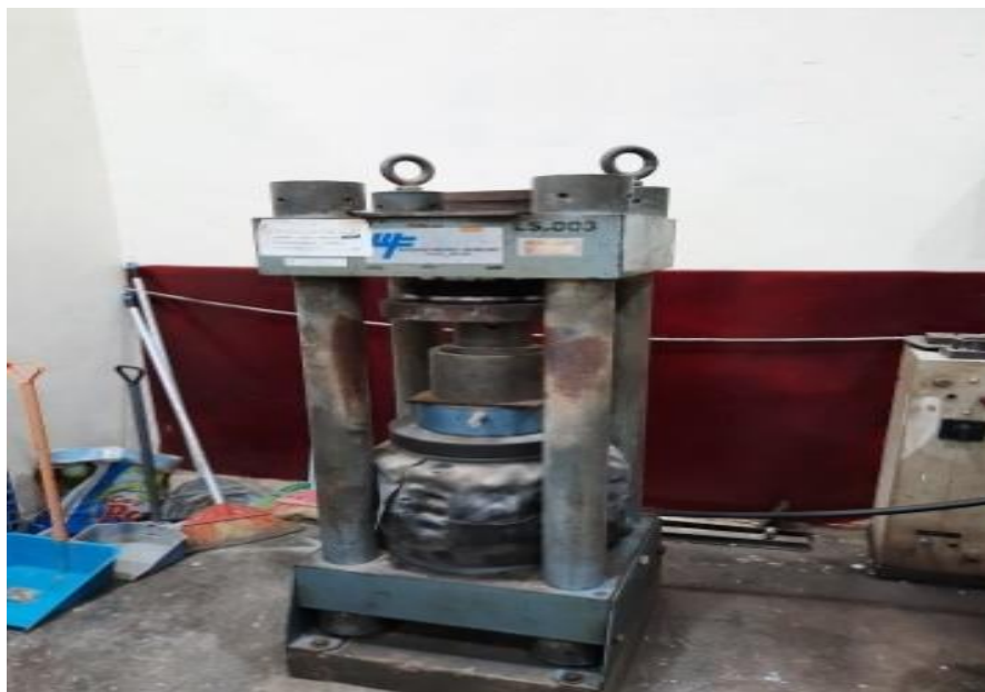
Gambar 20. Bejana ditekan selama 10 menit dengan beban 40 KN menggunakan alat kuat tekan
