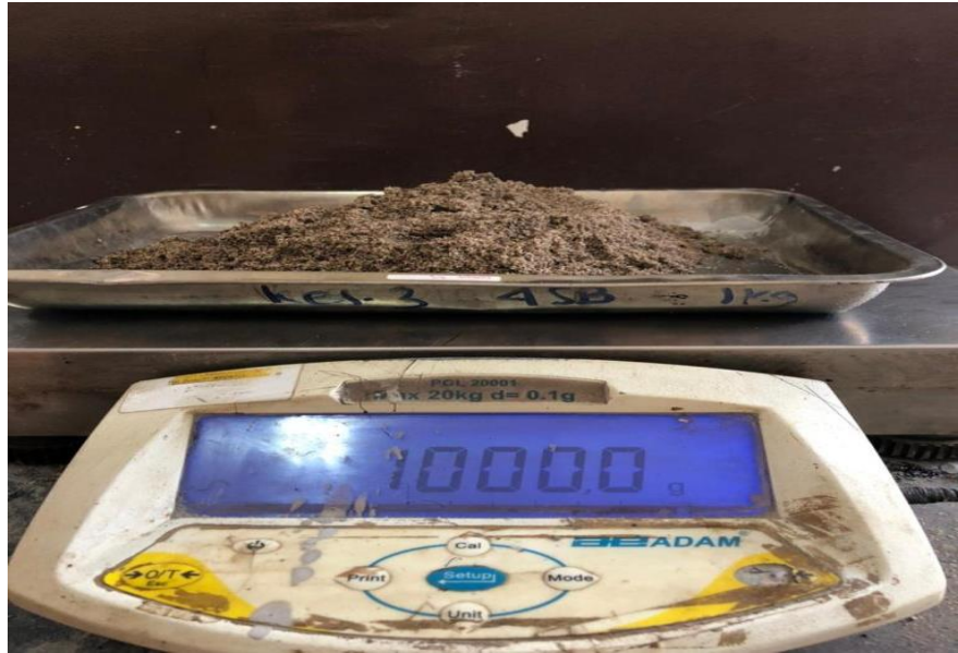
Gambar 9. Penimbangan Agregat Halus
