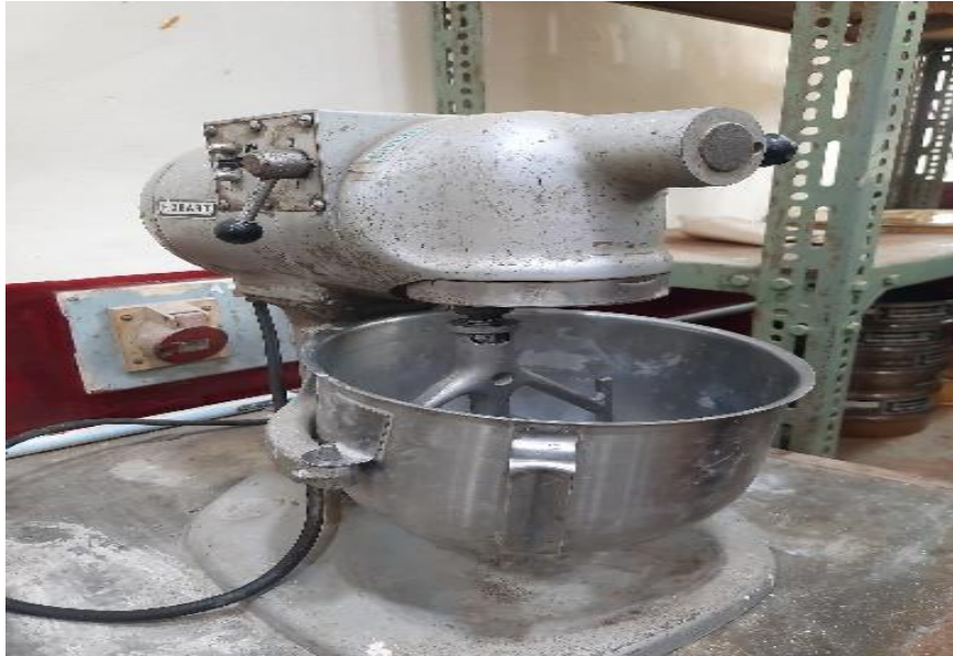
Gambar 31. Pembuatan pasta semen dengan menggunakan alat mixer
