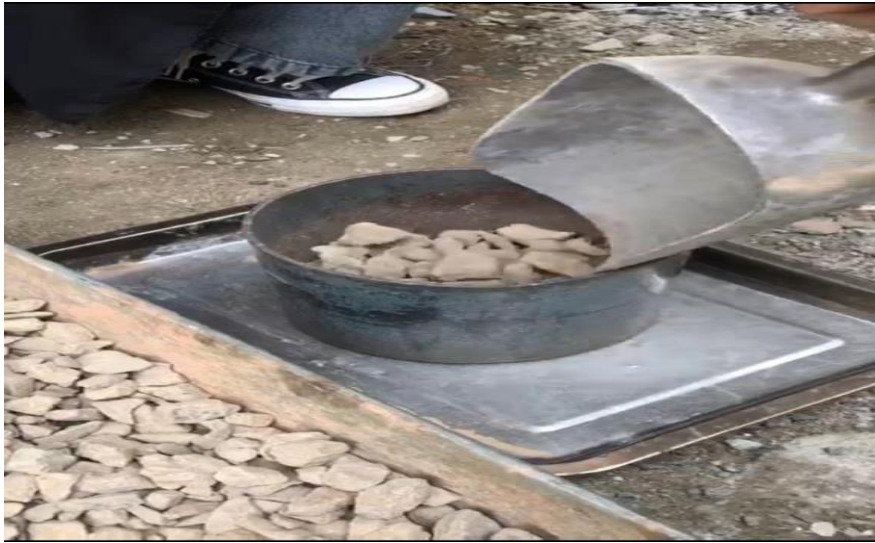
Gambar 15. Benda uji berupa agregat kasar dimasukkan kedalam bejana silinder
