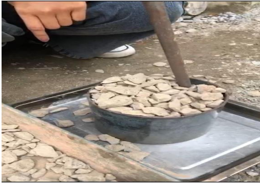
Gambar 17. Pada pengujian bobot isi padat bejana diisi agregat kasar dalam 3 lapis dan ditumbuk sebanyak 25 kali dengan tongkat penumbuk
