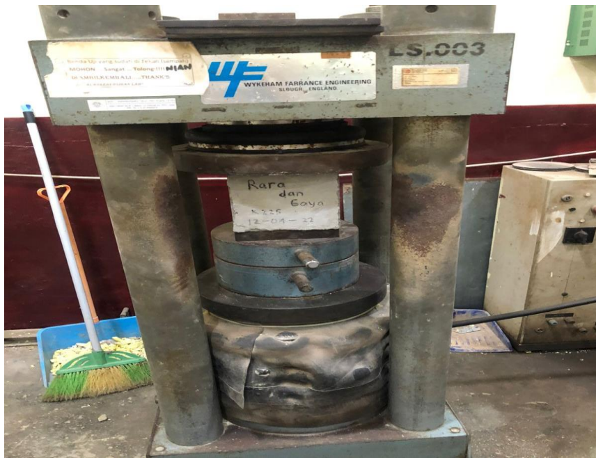
Gambar 39. Benda uji diletakkan pada mesin tekan secara simetris.
