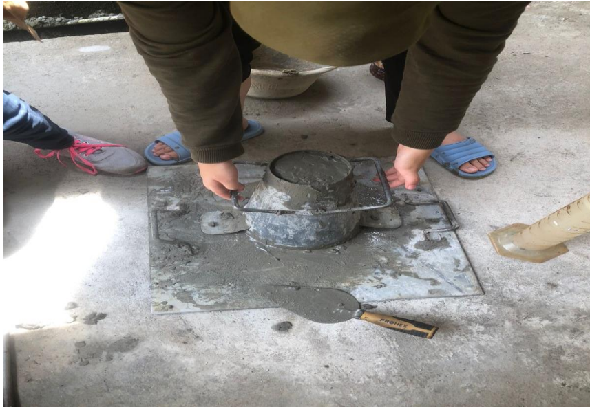
Gambar 23. Kerucut Abrams ditarik vertikal keatas secara perlahan
