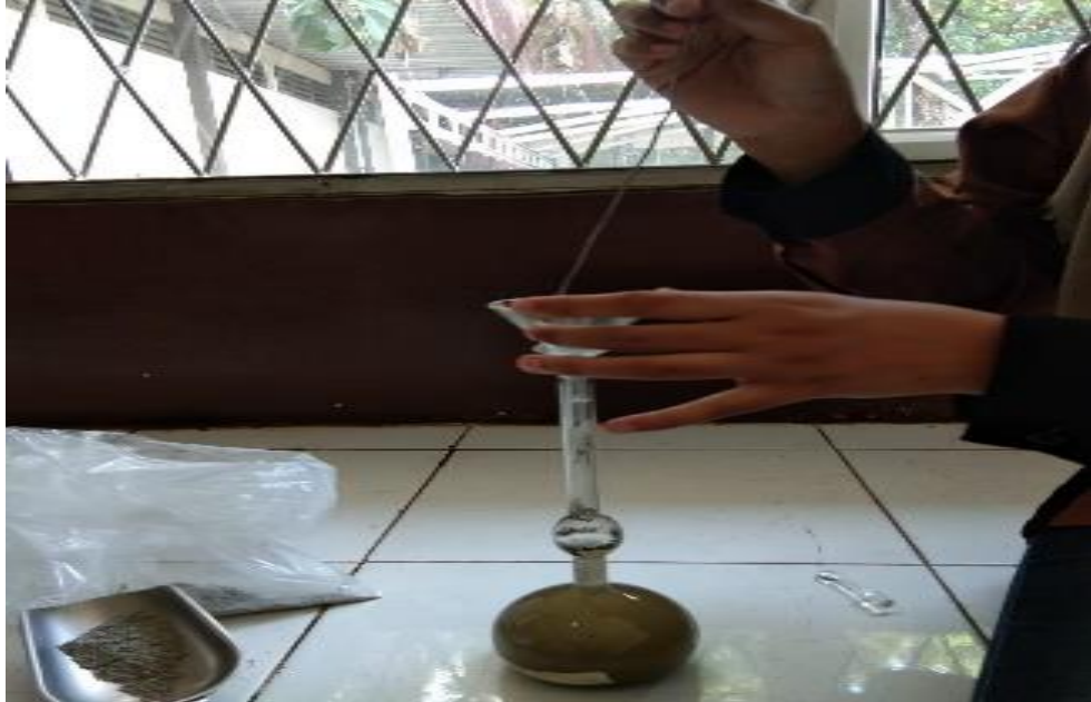
Gambar 26. Minyak tanah dituangkan kedalam tabung Le Chatelier Flask hingga skala 0-1 cm
