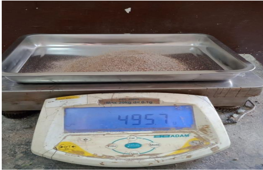
Gambar 7. Agregat halus dikeluarkan dari dalam piknometer dan di oven hingga berat konstan.
