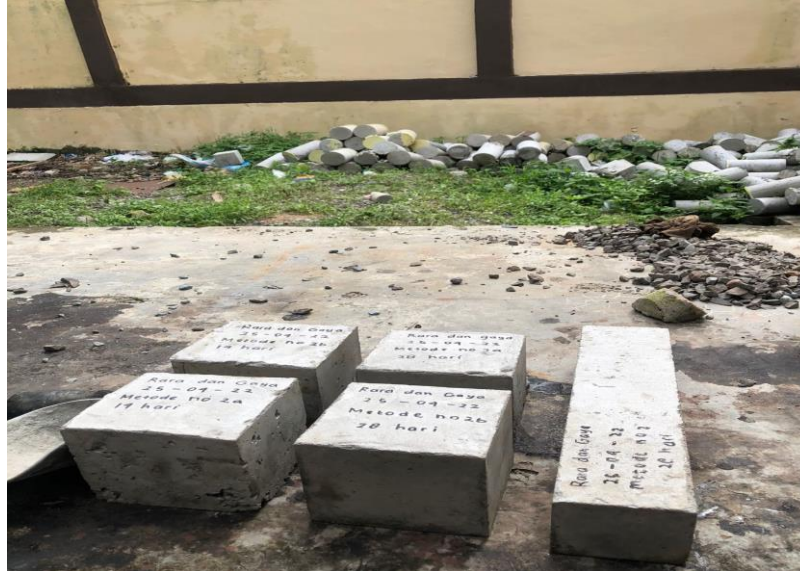
Gambar 45. Beton metode tanpa perawatan dibiarkan di alam terbuka.
