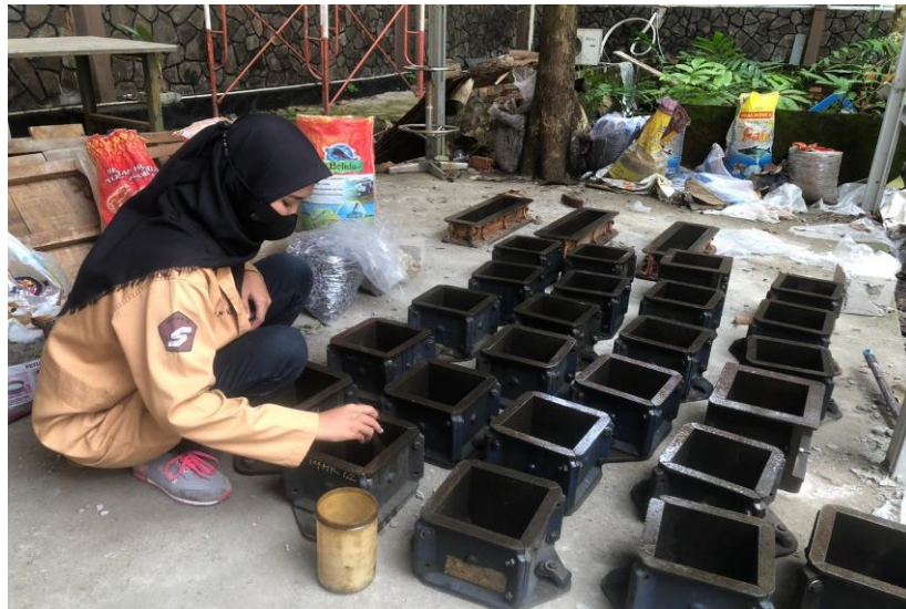
Gambar 36. Cetakan benda uji kubus dioleskan oli sebelum dimasukkan campuran beton
