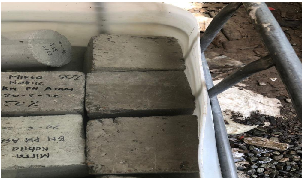
Gambar 50. Beton metode dengan merendam benda uji selama 24 jam
