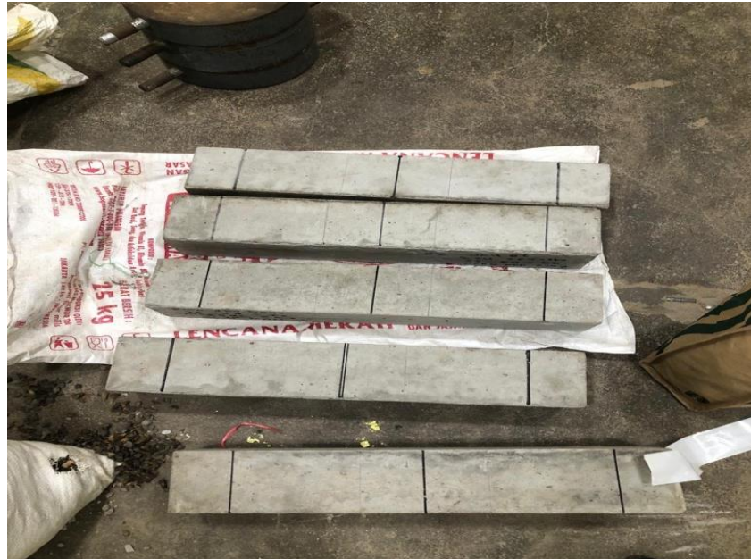
Gambar 41. Membuat Garis melintang pada benda uji sebagai penanda dan petunjuk titik perletakan dan titik pembebanan.
