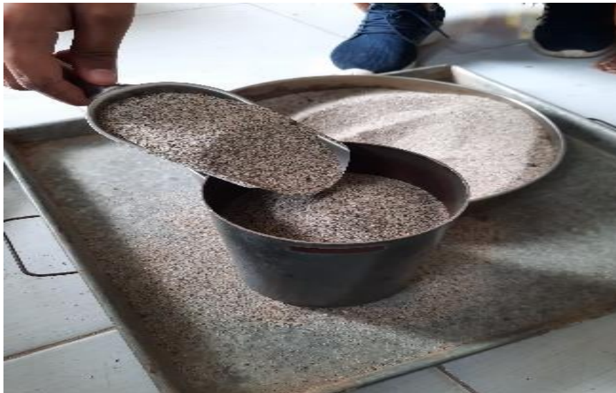
Gambar 12. Benda uji berupa agregat halus dimasukkan kedalam bejana silinder
