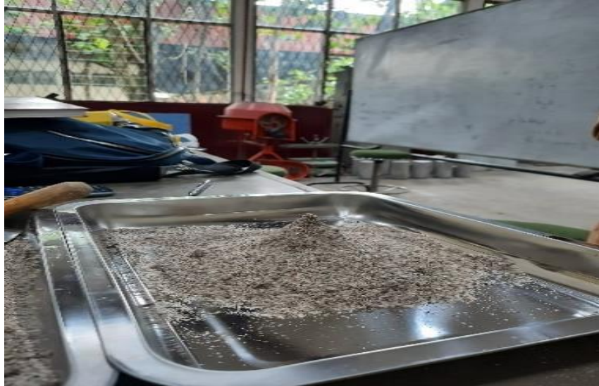
Gambar 5. Pengujian Saturated Surface Dry (SSD) menggunakan alat kerucut terpancung
