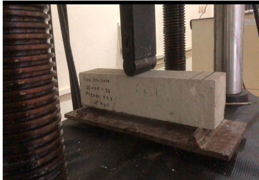
Gambar 43. Diletakan benda uji di atas dudukan yang telah disiapkan serta diatur benda uji berada tepat ditengah-tengah beban mesin uji tekan.
