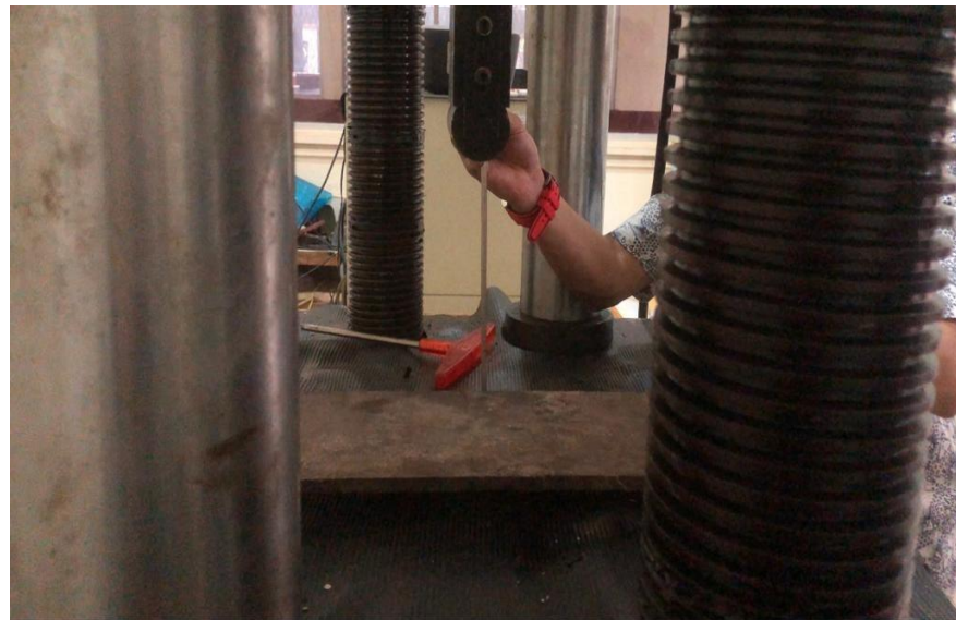
Gambar 42. Diletakan dudukan benda uji di mesin kuat lentur serta atur agar dudukan berada ditengah pada mesin pengujian kuat lentur.
