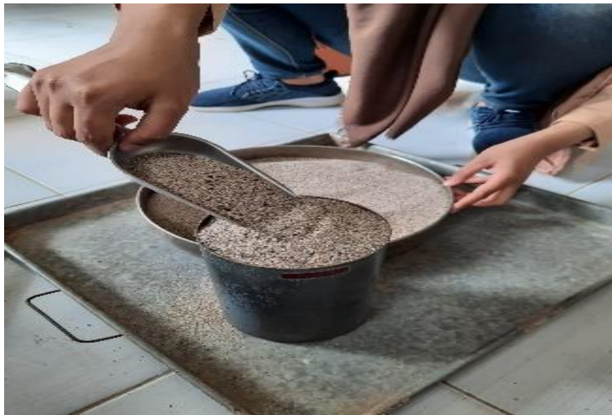
Gambar 14. Pada pengujian bobot isi padat bejana diisi agregat halus dalam 3 lapis dan ditumbuk sebanyak 25 kali dengan tongkat penumbuk
