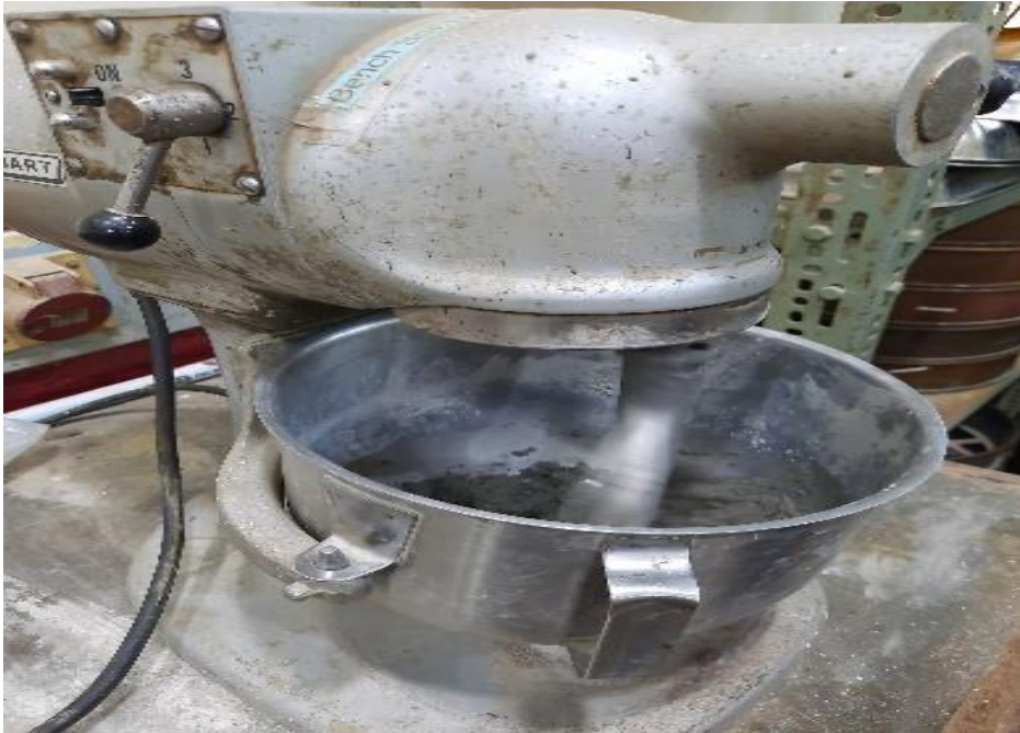
Gambar 29. Pembuatan pasta semen dengan menggunakan alat mixer
