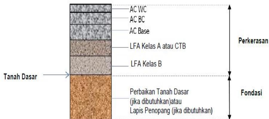
**Gambar 2.17** Perkerasan Lentur Pada Permukaan Tanah Asli
