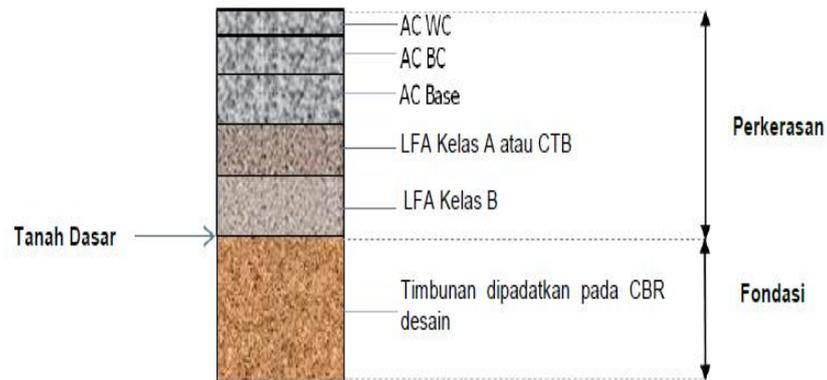
**Gambar 2.18** Perkerasan Lentur pada timbunan
