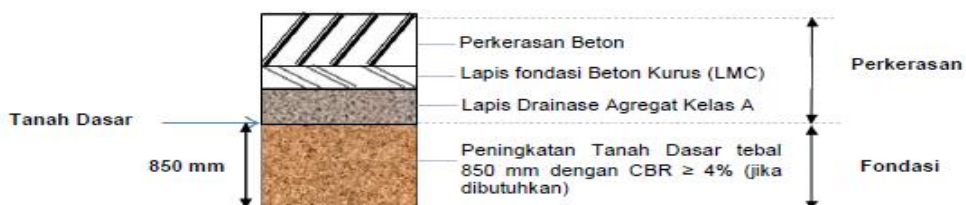
Gambar 2.17 Tipikal Perkerasan Kaku Pada Galian
