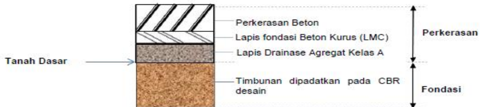
Gambar 2.16 Tipikal Perkerasan Kaku Pada Timbunan
