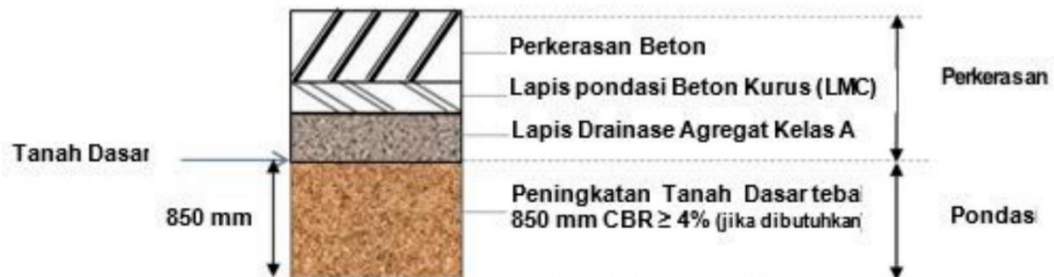
Gambar 2.24 Tipikal Perkerasan Kaku Pada Galian (Sumber : Manual desain perkerasan jalan Na.04/SE/Db/2017)
