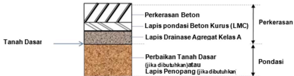
Gambar 2.22 Tipikal Perkerasan Kaku Pada Permukaan Tanah Asli ( at grade ) (Sumber : Manual desain perkerasan jalan No.04/SE/Db/2017)
