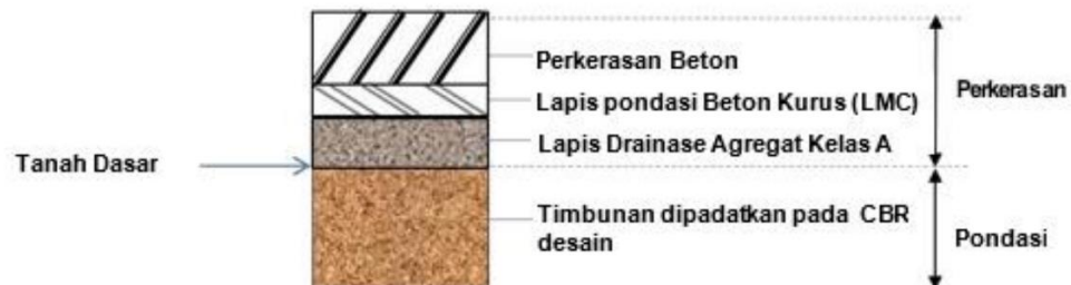
Gambar 2.22 Tipikal Perkerasan Kaku Pada Permukaan Tanah Asli ( at grade ) (Sumber : Manual desain perkerasan jalan No.04/SE/Db/2017)
