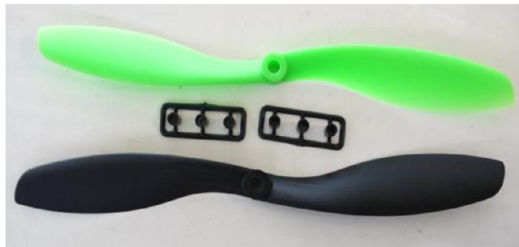
Gambar 2.23 Baling baling cw dan ccw
