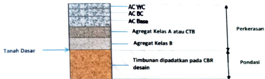
Gambar 2.28 Lapisan Perkerasan Lentur Pada Timbunan
