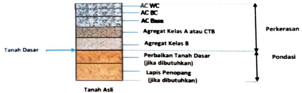
Gambar 2.27 Lapisan Perkerasan Lentur Pada Permukaan Tanah Asli
