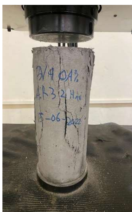
Pengujian Kuat Tekan
