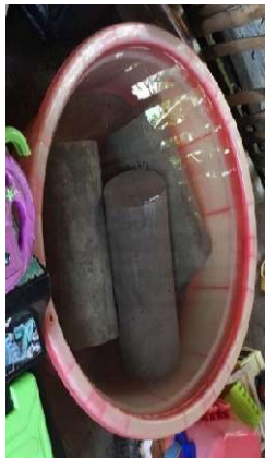
Perawatan Benda Uji
