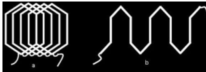
Gambar 2. 9 Bentuk kumparan a)Gelung b)Gelombang
