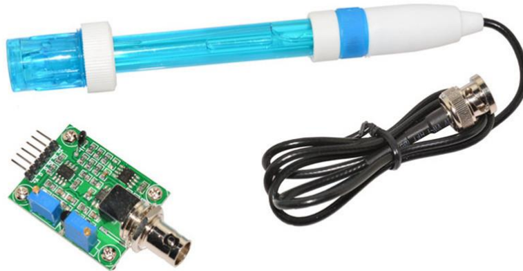
Gambar 2.7 Modul pH sensor pH 4502C dan probe konektor BNC E-201-C-9 Sumber : www.eprints.umg.ac.id
