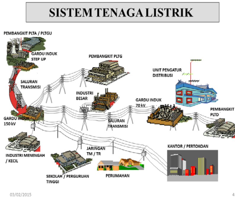
Gambar 2.1 Sistem Tenaga Listrik
