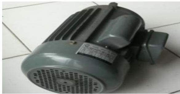
Gambar 2.22 Bentuk fisik motor kapasitor
