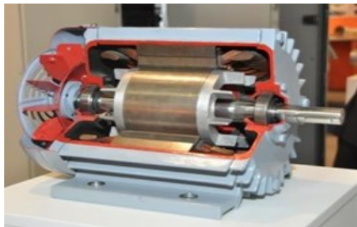
Gambar 2.25 Stator Dan Rotor Motor Universal
