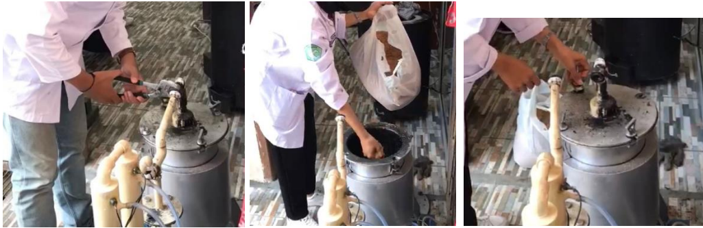
Gambar L3.7 Proses Membuka Reaktor, Memasukkan Bahan, Dan Menutup Reaktor
