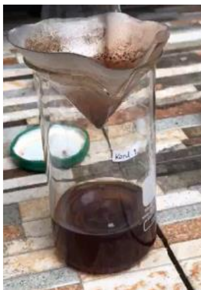
Gambar L3.12 Proses Penyaringan Asap Cair Dari Tar
