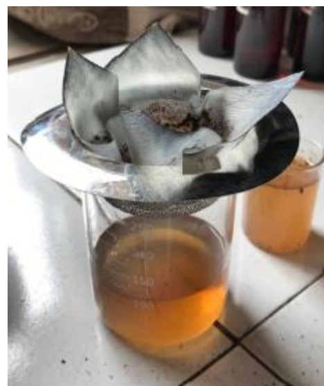
Gambar L3.12 Proses Penyaringan Asap Cair Dari Tar
