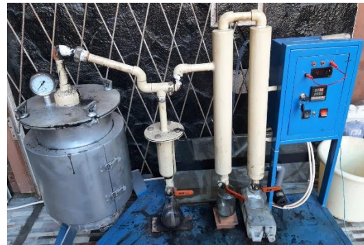
Gambar L3.9 Seperangkat Alat Pirolisis Asap Cair
