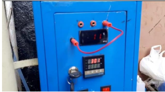
Gambar L3.11 Alat Ukur Suhu pada Reaktor, Tar, Kondensor 1, Dan Kondensor 2
