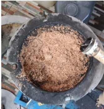
Gambar L3.8 Proses Pengisian Bahan Baku kedalam reaktor
