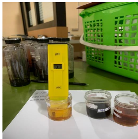
Gambar L3.19 Analisa pH dengan pH meter
