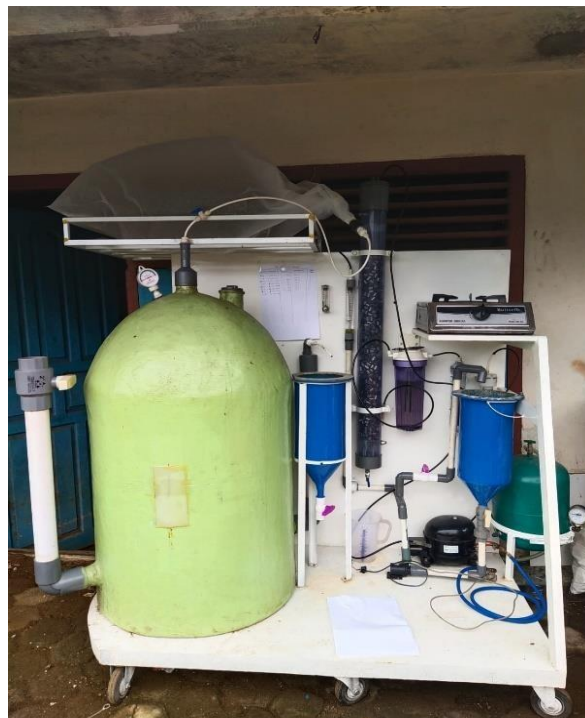
Gambar 2c . Alat digester dan Scrabber dalam satu unit
