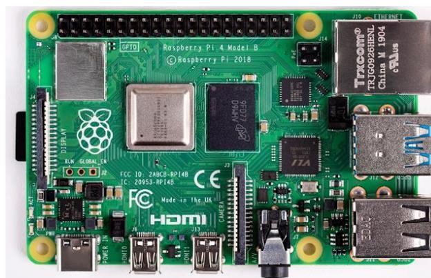
**Gambar 2.7** Raspberry Pi 4 Model B<sup>[6]</sup>
