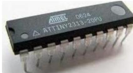
Gambar 2.5 Mikrokontroler *attiny 2313*
