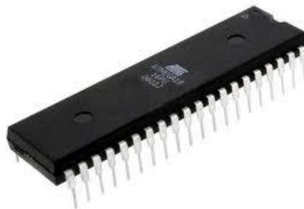
**Gambar 2.9** Mikrokontroler ATmega 16
