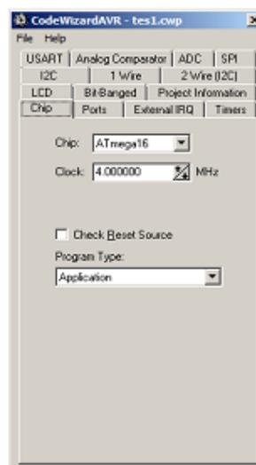
Gambar 2.14 pengaturan chip pada CodeVisionAVR
