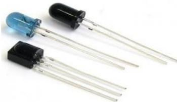
Gambar 2.4 Bentuk LED Infra Merah
