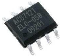
Gambar 2.16 Bentuk Fisik Sensor ACS712
